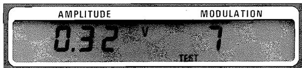
Anzeige von Testpunkt (rechts) und Spannungswert (links)
