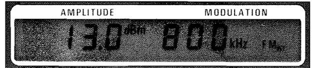
Anzeige von Pegel (mit Einheit) und Modulation mit Betriebsart (FM<sub>INT</sub>)
