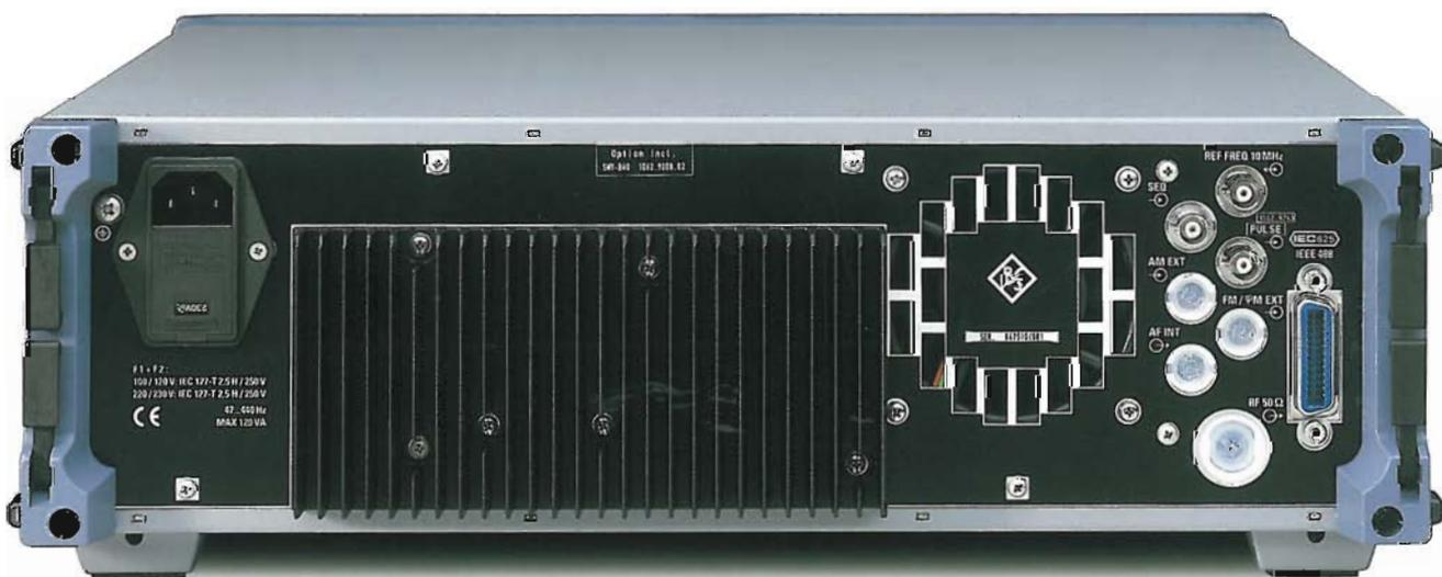
Anschlüsse an der Geräterückseite der SMY
